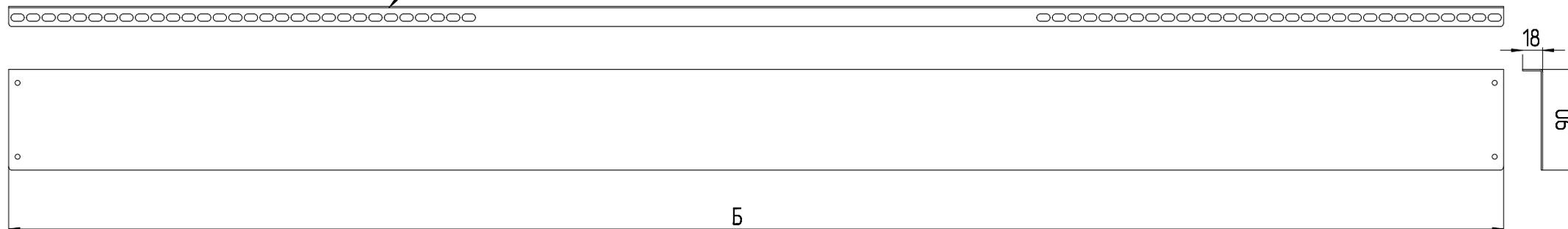
Назначение – панель торцевая увеличивающая изоляцию по высоте прохода, путем наращивания стоек и панелей в проходе.
