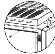
Регулировать силу прижима крыши к каркасу шестью (для ШТВ-2 - пятью) винтами М6 в крыше каркаса изнутри шкафа. Установка крыши производится в обратном порядке.
