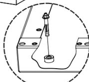
**3** Установите шкаф на основание, закрепите винтами М6х12.
