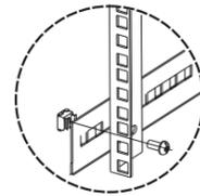
**6** Для доступа к транспортировочным ушам необходимо открутить два винта (для ШТВ-2 - четыре) М6х16 со стороны двери и потянуть крышу на себя.
