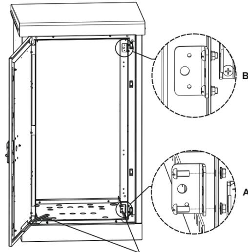
Для блокировки двери применить один уголок из комплекта поставки и один уголок демонтировать с ограничителя двери (уголки одинаковые).
