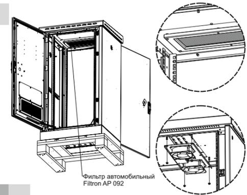
Предусмотрена установка модуля вентиляторного потолочного по ТУ РБ 800008148.004-2005 в крышу или дверь шкафа. Установите модуль и зафиксируйте четырьмя винтами М5.
