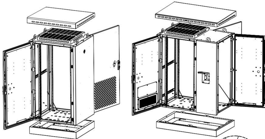
**2** Установите основание на подготовленную поверхность и закрепите болтами М12 либо анкерами. По контуру основания нанесите герметик (в комплект поставки не входит).
