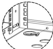
**4** Предусмотрена установка шкафа без демонтажа основания. Для доступа к монтажным отверстиям основания уберите 4 заглушки с внутренней стороны шкафа. Просверлите необходимые отверстия, закрепите шкаф анкерными винтами М12 (в комплект поставки не входят), установите заглушки.
