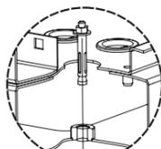
**5** Вертикальные направляющие (4 шт.) регулируются по глубине. Фиксируются винтом и гайкой с фиксатором.
