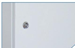
Дверь выполнена из стали 1,5 мм, имеет пенорезиновый уплотнитель, надежно фиксируется точечным замком, в шкафах большого размера устанавливаются два замка. Дверь имеет заземление, угол открывания – 120°. Передняя рама шкафа имеет желоб, который дополнительно защищает оборудование от проникновения воды и грязи внутрь корпуса при открывании двери. Предусмотрена возможность установки дополнительного оборудования на внутреннюю плоскость двери.
